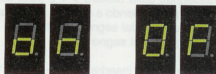
Fig.11 La prima volta che usate il timer, premete il pulsante Mode fino a quando non compare la scritta "on". Per disinserire l'allarme sonoro premete il pulsante - e sui display comparirà la scritta "OF".
