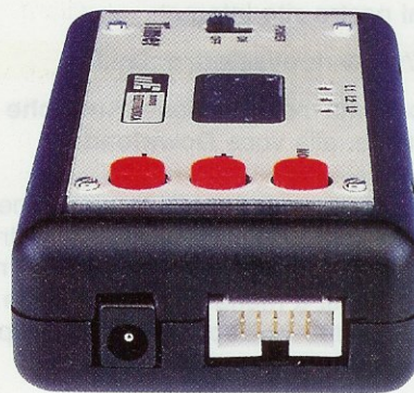
Fig.13 I connettori visibili nella foto, presenti su un lato del circuito stampato, vi servono per riprogrammare il micro. Il connettore a sinistra relativo ai 5,6 volt deve essere collegato all'alimentatore LX.1203, mentre il connettore a destra a 10 poli deve essere collegato al programmatore LX.1546 (vedi fig.14).
