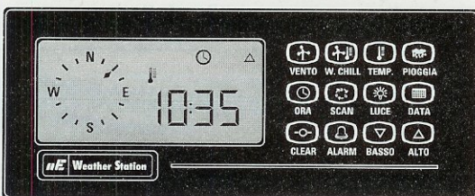
Fig.43 Successivamente anche il valore della temperatura massima scomparirà dal display per lasciar posto all'ora della giornata nella quale il massimo di temperatura è stato registrato.
