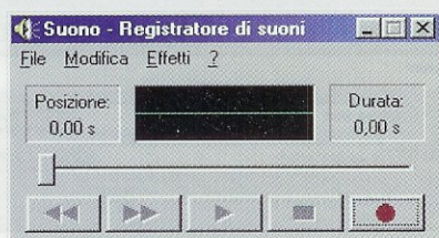
Fig.6 La finestra Registratore di Suoni ha gli stessi comandi di un comune registratore a cassetta: i primi due pulsanti da sinistra servono per il riavvolgimento, poi, nell'ordine, trovate i pulsanti Play-Suona, Stop e, per ultimo, il pulsante Registra.
