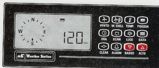
Fig.33 Una volta che il display avrà terminato di lampeggiare, potrete impostare il valore desiderato di pioggia caduta premendo ripetutamente il tasto ALTO oppure il tasto BASSO.
