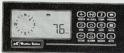
Fig.50 Dopo qualche secondo vedrete scomparire la data di ieri e il simbolo del calendario, per lasciar posto al valore delle precipitazioni di ieri. Tale valore e la data si alterneranno quindi sul display.
