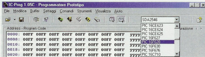
Fig.33 Con il programma IC-Prog e il nostro programmatore è possibile programmare numerosi tipi di PIC (vedi tabella N.1). Per collaudare la scheda sperimentale LX.1582, selezionate dal menu a discesa il PIC 16F628.
